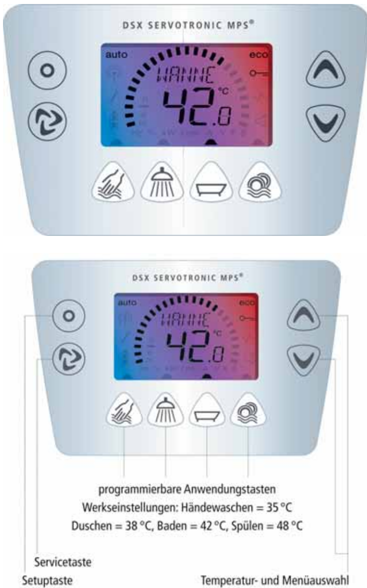
Bild 4 (a,b) • Das Multifunktionsdisplay ist intuitiv zu bedienen und zeigt diverse Betriebsinformationen.
