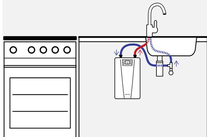
Raccordement au réseau avec **boîtier de délestage LAB** uniquement à un seul raccordement 400 volts prévu pour une cuisinière, s'il n'est pas possible d'assurer une alimentation indépendante pour le chauffe-eau instantané.
