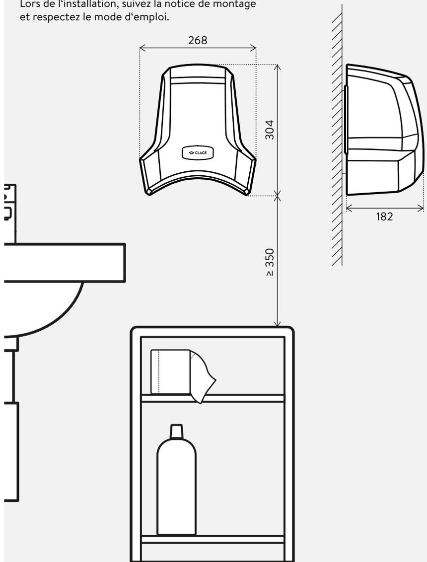
Dans des locaux abritant des douches et des baignoires, l'appareil ne doit pas être monté à l'intérieur des zones de sécurité spécifiées dans les prescriptions VDE.
